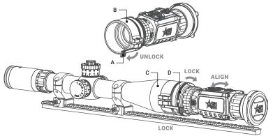
FIGURE 2-6. CLIP-ON INSTALLATION
