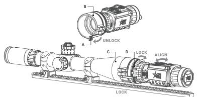
FIGURE 2-7. CLIP-ON INSTALLATION
