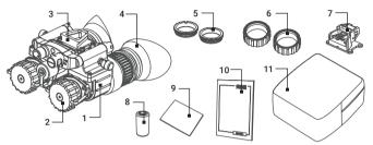
FIGURE 1-2. NVG-40/NVG-50 STANDARD COMPONENTS
