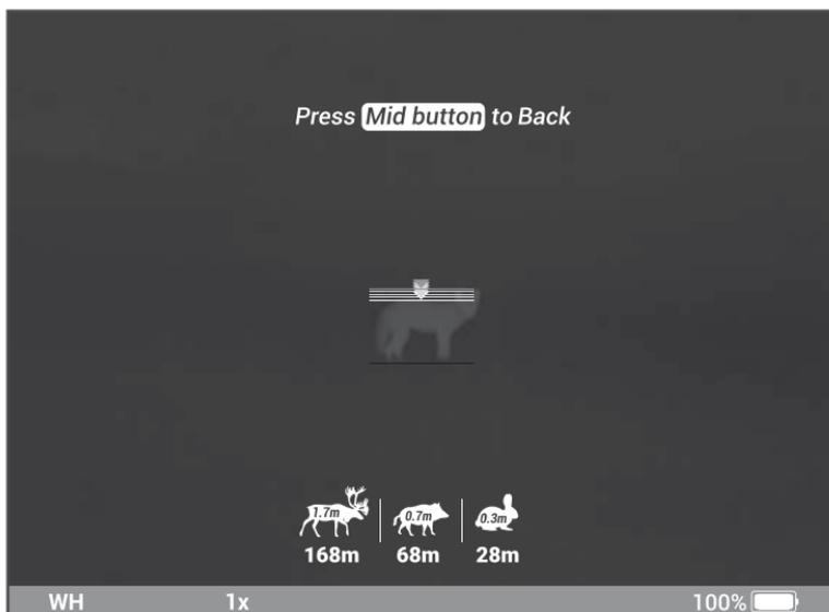
FIGURE 2-9. STADIAMETRIC RANGEFINDER
